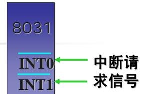
外部中断请求信号触发方式选择 (IT0/1位)
