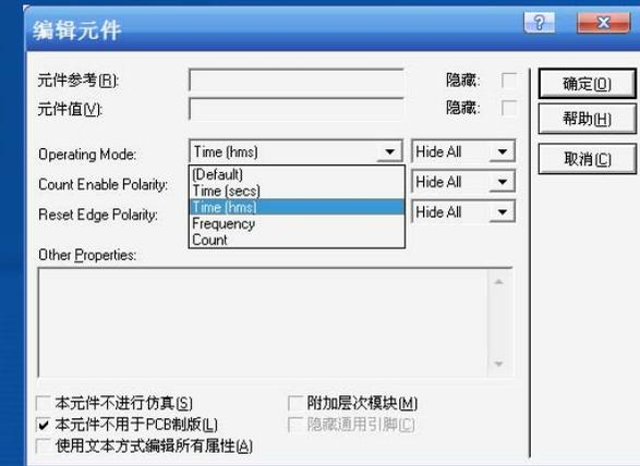
图4-69 计数器/定时器的工作方式设置
