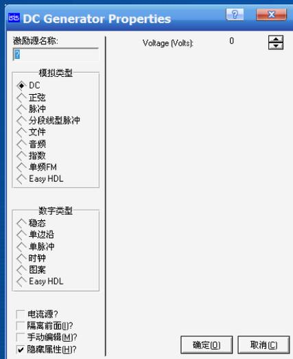
图4-40 直流信号源属性设置对话框
