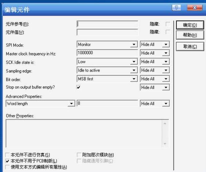
图4-65 SPI调试器属性设置对话框
