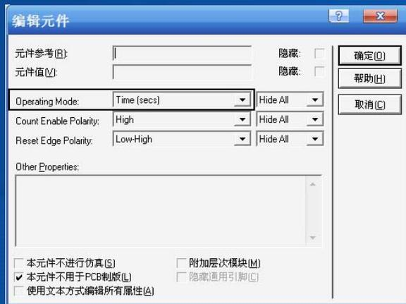
图4-68 计数器/定时器的属性设置窗口与工作方式设置
