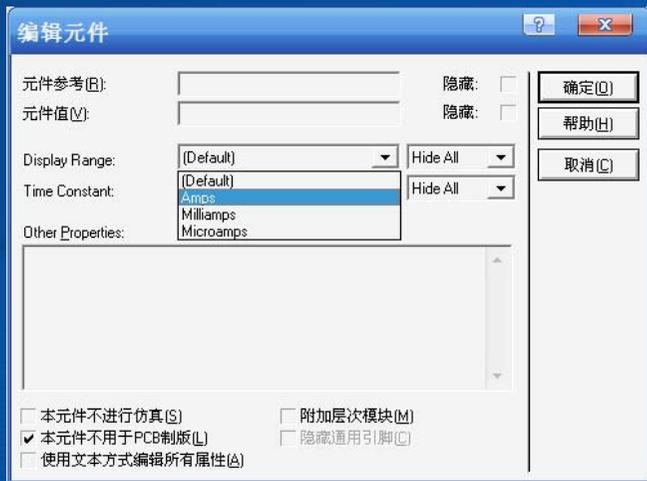
图4-73 直流电流表的属性设置对话框
